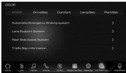
【Sistema de frenado de emergencia automático】: Puede activar o desactivar las funciones Crash Safety Assist y Pedestrian Safety Assist, y ajustar la sensibilidad de alerta.
